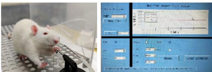
大鼠上肢三维力拉杆式系统是一种用于研究小型实验动物(例如小鼠或大鼠)行为学、学习、记忆以及神经科学研究的实验装置。该系统结合了力传感器和水奖励系统, 旨在通过对动物行为的精确监测和奖励的提供, 深入了解动物在不同条件下的行为表现和神经机制。
